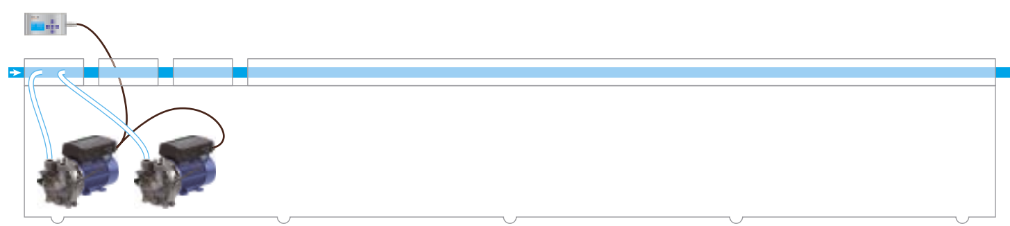
Installationsbeispiel für die Regelung eines Druckniveaus mit zwei Vakuumeinheiten mittels der Software-Funktion Master-Slave
