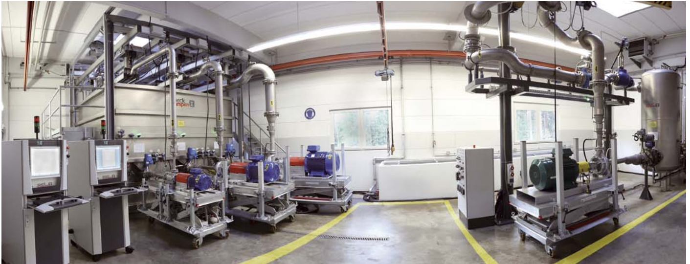
Computergesteuerte und vollautomatisierte Prüfstände im Werk von Speck in Roth.
